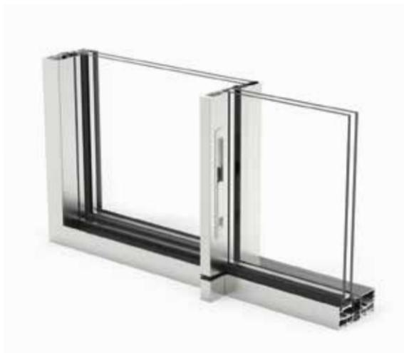
Sistema de corredera minimalista con rotura de puente térmico que ofrece la máxima luminosidad con la mínima sección vista de aluminio. Presenta un diseño elegante con un nudo central de solo 20 mm, y ofrece la posibilidad de ocultar el marco perimetralmente.
